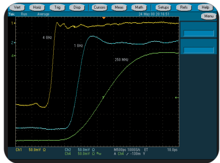
► Abbildung 47. Je höher die Bandbreite, desto genauer ist die Reproduktion des Signals; dies wird hier mit einem Signal veranschaulicht, das bei den Bandbreitenwerten 250 MHz, 1 GHz und 4 GHz erfasst wurde
