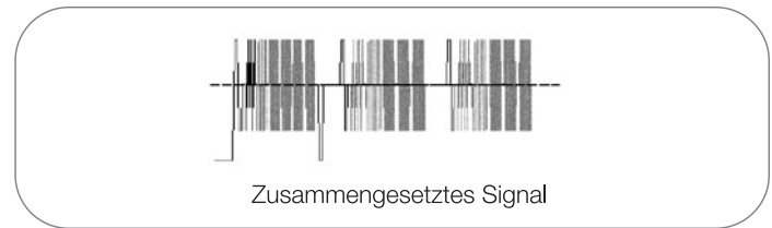
► Abbildung 9. Ein NTSC-Composite-Videosignal ist ein Beispiel eines zusammengesetzten
