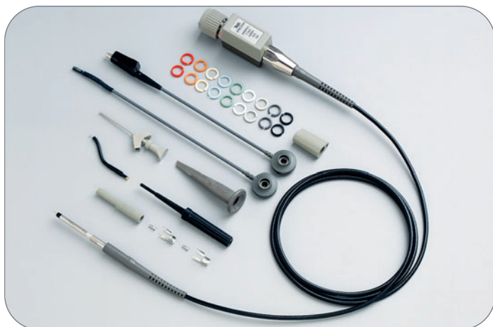
► Abbildung 41. Ein üblicher passiver Tastkopf mit Zubehör
