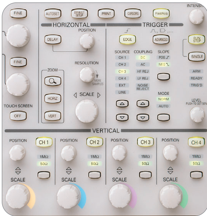
► Abbildung 22. Bedienenelemente auf der Frontplatte eines Oszilloskops
